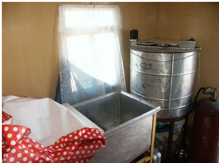
Laboratorio di smielatura in Kazakistan: attrezzi auto-costruiti in lamiera zincata. Il locale è ricavato nel carro con il quale vengono trasportati gli alveari per itinerari che durano alcuni mesi. Nel medesimo locale mangia e dorme l'apicoltore con la sua famiglia. Ovviamente non ci sono servizi igienici ed acqua.
